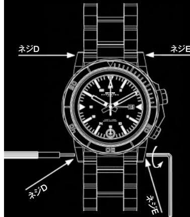
付属の六角レンチ（インチ）を使用します。最初のネジ（ネジD）を六角レンチ（インチ）で押さえながら（図参照）、反対側のネジ（ネジE）をもう一つの六角レンチ（インチ）で（反時計回りに）緩めます。六角レンチ（インチ）の長手を使って慎重にネジ（ネジD）を押し出します。
